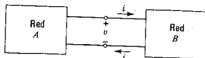
Figura 9-23. Dos redes en función de las cuales se describe el teorema de Thévenin.
